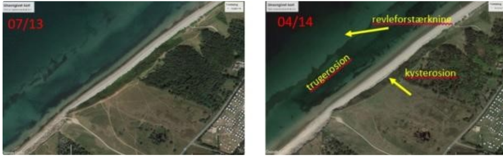
Figur 1. Google Earth billeder som viser kystændringer ved Heatherhill før (7. juli 2013) og efter (4. april 2014) stormen Bodil i december 2013. Illustration: Google Earth.
